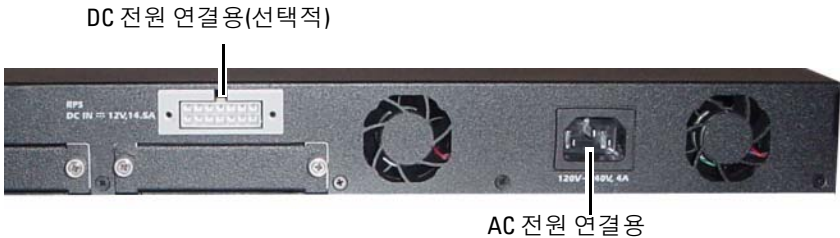
그림 1-15. 스위치에 AC 및 DC 전원 연결
